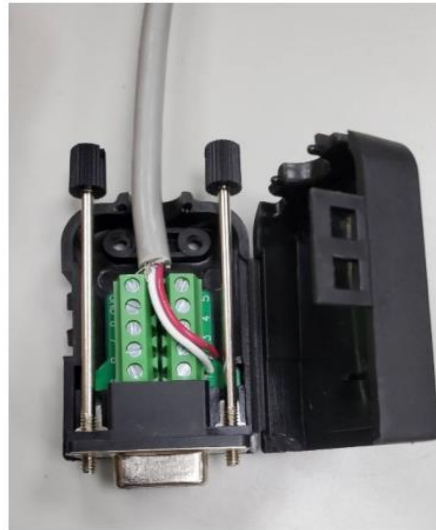
2. pin1 接 A, pin2 接 B, 將信號線固定鎖好
